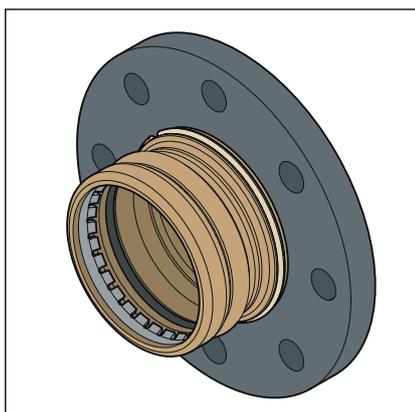
Abb. 6: Losflansch
