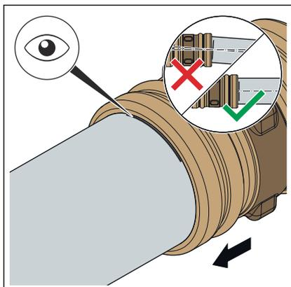
Den Pressverbinder bis zur markierten Einstecktiefe auf das Rohr schieben. Den Pressverbinder nicht verkanten.
