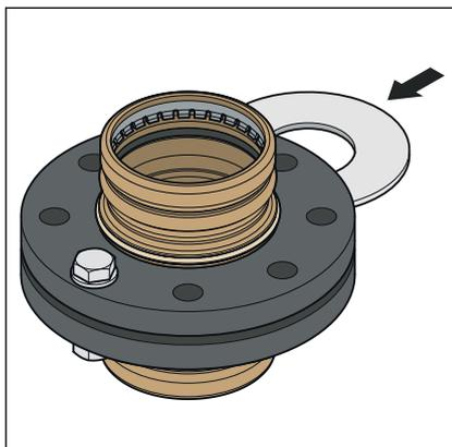
Die richtige Montage von Flanschverbindungen setzt parallel fluchtende Flanschblätter ohne Mittenversatz voraus, die ein positionsgerechtes Einbringen des Dichtelements ohne Beschädigung erlauben.
