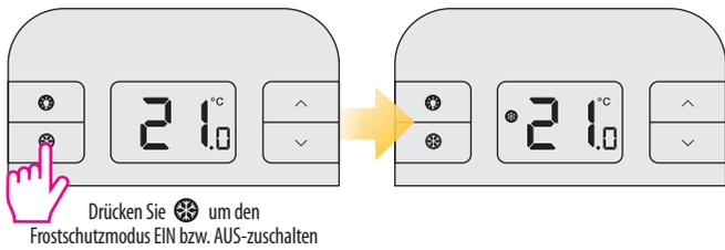
**i** Die Frostschutztemperatur kann angezeigt werden, wenn der  $\wedge$  Schalter einmal gedrückt wird, kann aber nur im Installateurs-Modus geändert werden.
