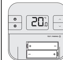
Nehmen Sie die Batterien heraus, ohne auf eine Taste zu drücken. Warten Sie 2 Minuten und setzen Sie dann die Batterien wieder ein. Ihr Gerät wird neu gestartet.
