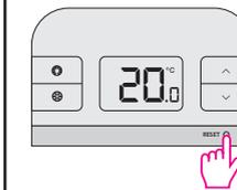
Um den Thermostaten auf Werkseinstellungen zurückzusetzen, drücken Sie bitte die RESET Taste.
