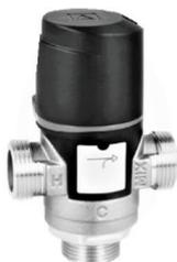
Die Regelung der Vorlauftemperatur wird mit dem thermischen 3-Wege-Mischventil über einen Regelknopf fest eingestellt. Die Temperatur kann problemlos zwischen 30 und 60 °C auf die gewünschte Mischtemperatur eingestellt werden. Eine Schutzhaube schirmt den Regelknopf vor unsachgemäßer Bedienung ab und kann verplombt werden. Durch ein Sichtfenster in der Haube ist der gewählte Einstellbereich sichtbar. Das Ventil ist wartungsfrei.
