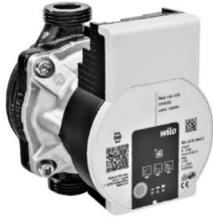
Zur Versorgung der Radiatoren ist die Umwälzpumpe werkseitig in der Elektro-Anschlussbox auf der Verdrahtungsplatine aufgelegt. Über die Einstellmöglichkeit am Pumpenkopf werden die erforderlichen Versorgungsparameter eingestellt. Diese können wahlweise über Differenzdruck konstant oder variabel mit jeweils 3 Kennlinien oder eine Drehzahlregelung in den Stufen 1 bis 3 geregelt werden.
