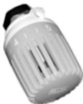
Mit dem Thermischen-Fluid-Regler (TFR) kann eine Warmwassertemperatur zwischen 20 und 70 °C schnell und exakt geregelt werden. Unmittelbar im Warmwasseraustritt des Wärmetauschers befindet sich der zugehörige Temperatur-Wendelfühler, der über ein Kapillarrohr mit dem Regler verbunden ist.
