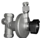
Der Differenzdruckregler Heizung ist zur Durchführung eines hydraulischen Abgleichs. Somit kann die Roth FlatConnect Wohnungsstation fachgerecht in das Anlagen-Rohrnetz eingebunden werden. Der Regler befindet sich im Rücklauf der Heizungsversorgung und ist über ein Kapillarrohr mit dem Vorlauf verbunden. Der einstellbare Differenzdruck befindet sich in einem Arbeitsbereich von 20 bis 65 kPa. Die Voreinstellung ist werkseitig auf 40 kPa eingestellt.
