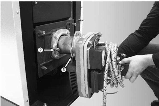
Abb. 4: Brennerbefestigung
