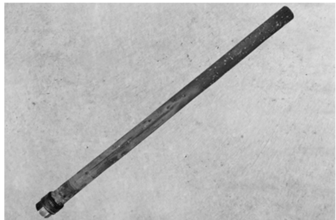
Abb. 87: Magnesium-Schutzanode, Länge 480 mm, Ø 26 mm
