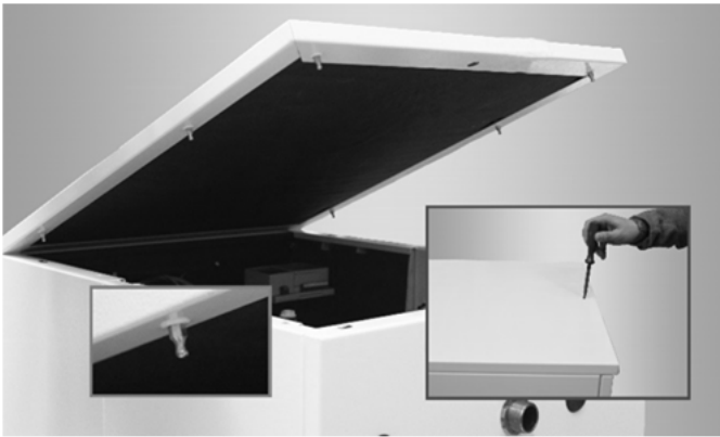
Abb. 58: Demontage der oberen Verkleidung
