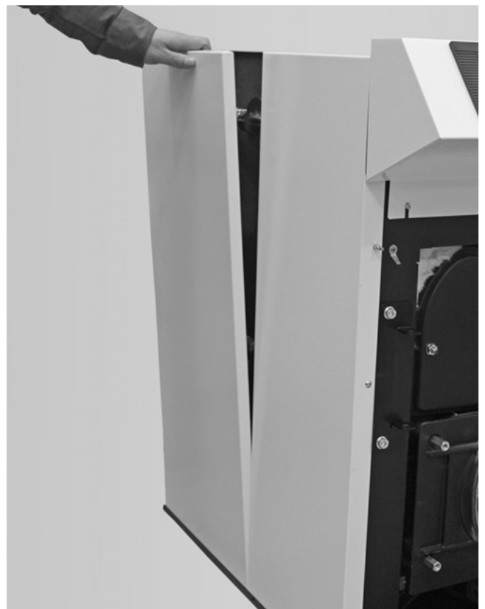
Abb. 61: Demontage der seitlichen Verkleidung
