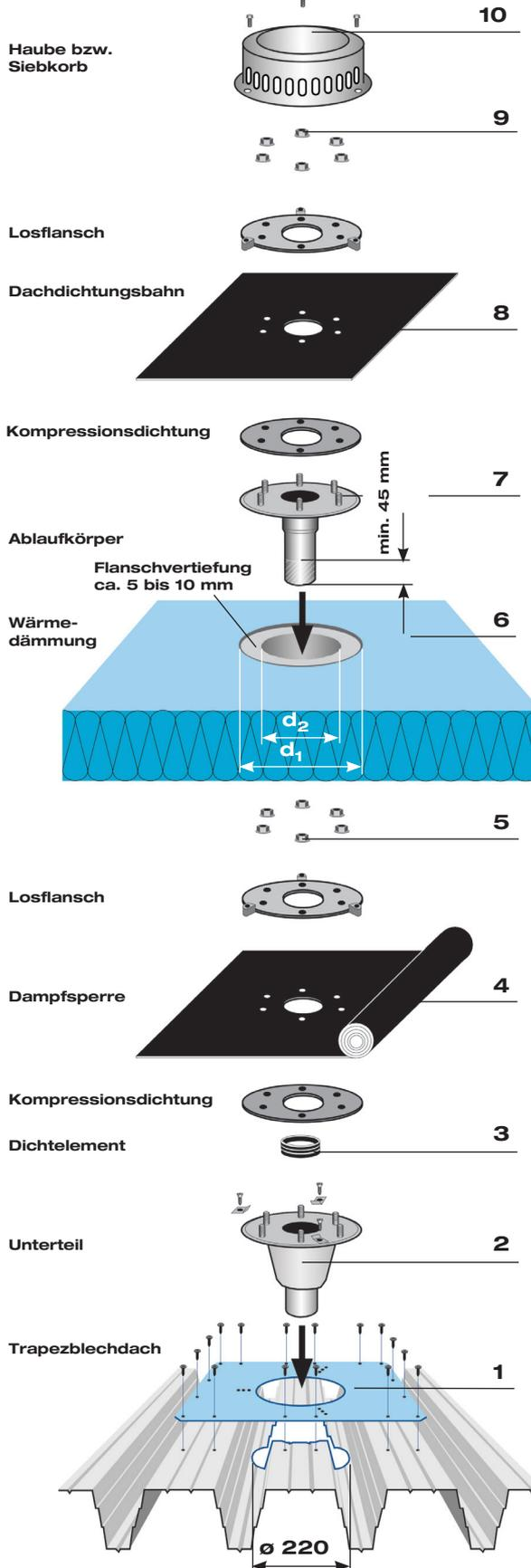
Haube bzw. Siebkorb mit beiliegenden 3 Stück Befestigungsschrauben mit Losflansch verschrauben. Befestigung handfest bis max. 5 Nm.
