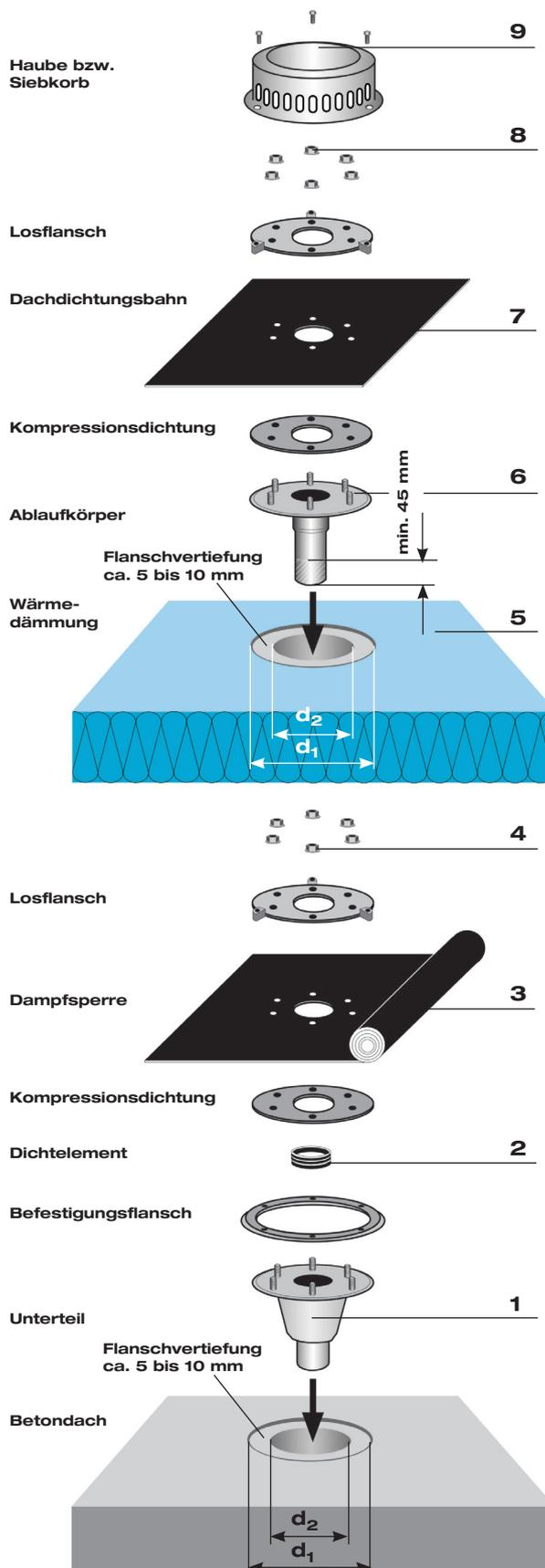
Haube bzw. Siebkorb mit beiliegenden 3 Stück Befestigungsschrauben mit Losflansch verschrauben. Befestigung handfest bis max. 5 Nm. Losflansch mit beiliegenden 6 Stück Sechskantflanschmutter M 10 mit Ablaufkörper verschrauben. Anzieh-Drehmoment: 20 Nm (Dachdichtungsbahn aus Bitumen) bzw. 30 Nm (Dachdichtungsbahn aus Kunststoff). Überstände der Abdichtungslage in den Einlaufbereich sind zu entfernen.
