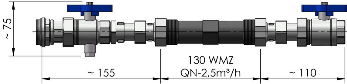
Kugelhähne DG mit Fühlerbohrung M10x1 für direkt eintauchende kurze Fühler,
