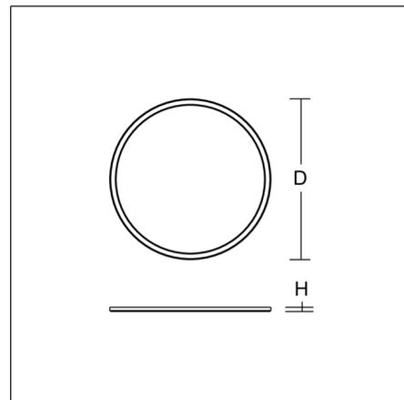
Speziell angepasste geschlossenzellige Silikonschaum-Dichtung zur Vermeidung der Verteilung von Keimen und Viren.
