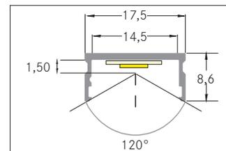
Anbauprofil, schwarz eloxiert. Zur optimalen Befestigung des Profiles eignen sich die Halter 53034000. In Verbindung mit den Profilabdeckungen 53440000 53440070 53440080 kann sowohl ein zusätzlicher mechanischer Schutz als auch eine optimale Lichtverteilung erreicht werden. Das zugehörige Endkappen-Set steht unter 53086 zur Verfügung. Montageart: Anbauprofil, Material: Aluminium, Abmessung Profil: L: 2.000 mm x B: 17,5 mm x H: 8,6 mm.
