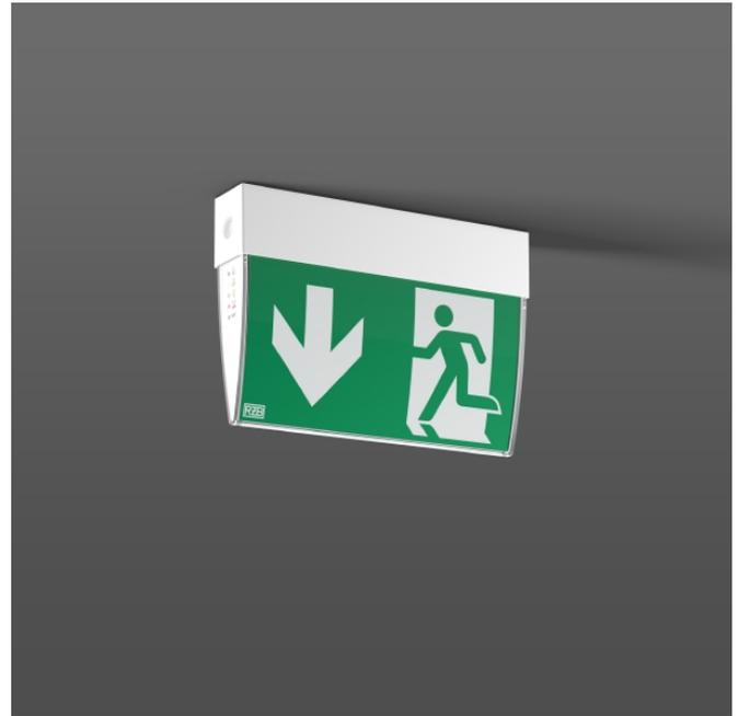
Gehäuse komplett aus Polycarbonat. Befestigungswinkel zur Wandmontage und zwei Dichtschrauben beige packt. Vier Folien mit Rettungszeichen zur Rettungswegkennzeichnung und eine weiße Folie beigelegt. Piktogrammfolien und weiße Folie zum Einlegen in die transparente Abdeckung. Einzelbatteriesystem mit automatischem Selbsttest. Leuchtmittel (LED) im Lieferumfang enthalten.
