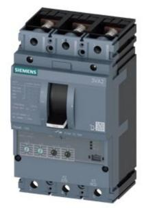
Leistungsschalter 3VA2 IEC Frame 160 Schaltvermögenklasse H Icu=85kA @ 415V 3-polig, Anlagenschutz ETU350, LSI, In=160A Überlastschutz Ir=63A...160A Kurzschlussschutz Isd=1,5...10 x Ir, Ii=10 x In Schraubenflachanschluss Leistungsschalter 3VA2 IEC Frame 160 Schaltvermögenklasse H Icu=85kA @ 415V UNTERSPANNUNGSAUSLOESER 208-230 V AC 50/60 HZ 3 HILFSSCHALTER HQ
