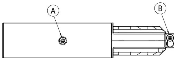
Abb. 1 Schrauben Einspeisung
