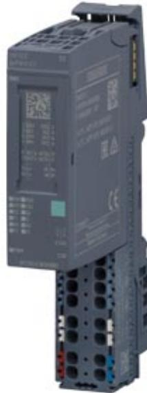
SIMATIC ET 200SP TM ECC 2xPWM ST Ladecontroller zum konduktiven Laden von Elektro- fahrzeugen gemäß IEC61851 mit 2 Ladeabgängen -30°C...60°C 2x Control Pilot 2x Plug Present 2x DQ Schaltkontakt für Lastschütz als Open Collector; 2x DI für Rückmeldung Lastschütz oder Steckerverriegelung; 2x ACT für Steckerverriegelung passend für BU Typ BU20-P12+A0+4B und BU20-P12+A4+0B
