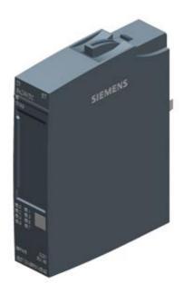
SIMATIC ET 200SP, Digitales Eingangsmodul, DI 8x 24VDC Standard, Eingangstyp 3 (IEC 61131), Sink Input, (PNP, P-lesend), Verpackungseinheit: 1 Stück, passend für BU-Typ A0, Farbcode CC01, Eingangsverzögerung 0,05..20ms; Modul-Diagnose für: Kurzschluss Geberversorgung, Drahtbruch, Versorgungsspannung
