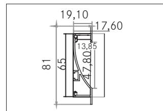
Wandeinbauprofil, alu eloxiert. Material: Aluminium, Abmessung Profil: L: 100 mm x B: 19,1 mm x H: 81 mm.
