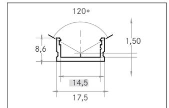
Anbauprofil, alu eloxiert. Material: Aluminium, Abmessung Profil: L: 100 mm x B: 17,5 mm x H: 8,6 mm.
