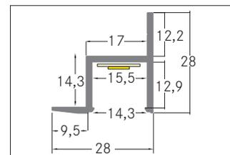
Deckeneinbauprofil mit Wandbefestigung, alu eloxiert. In Verbindung mit den Profilabdeckungen 53440000 53440070 53440080 kann sowohl ein zusätzlicher mechanischer Schutz als auch eine optimale Lichtverteilung erreicht werden. Montageart: Einbauprofil, Material: Aluminium, Abmessung Profil: L: 2.000 mm x B: 28 mm x H: 28 mm.
