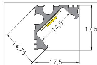
Anbau-Eckprofil, alu eloxiert. Zur optimalen Befestigung des Profiles eignen sich die Halter 53034000. In Verbindung mit den Profilabdeckungen 53440000 53440070 53440080 kann sowohl ein zusätzlicher mechanischer Schutz als auch eine optimale Lichtverteilung erreicht werden. Das zugehörige Endkappen-Set steht unter 53085260 zur Verfügung. Montageart: Eckprofil, Material: Aluminium, Abmessung Profil: L: 2.000 mm x B: 17,5 mm x H: 17,5 mm.
