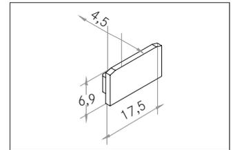
Endkappen-Set, weiß. In Verbindung mit den Profilabdeckungen 53440000 53440070 53440080 kann sowohl ein zusätzlicher mechanischer Schutz als auch eine optimale Lichtverteilung erreicht werden. Material: Kunststoff, Abmessung Profil: L: mm x B: 17,5 mm x H: 9,6 mm.
