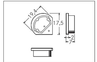
Endkappen-Set, silber. Material: Kunststoff, Abmessung Profil: L: mm x B: 19,4 mm x H: 17,5 mm.
