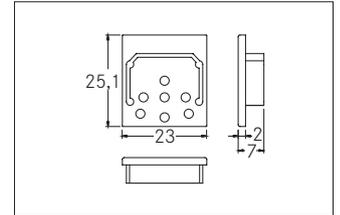
Endkappen-Set zu 53402. schwarz. In Verbindung mit den Profilabdeckungen 53402000 53402070 53402080 53432070 kann sowohl ein zusätzlicher mechanischer Schutz als auch eine optimale Lichtverteilung erreicht werden. Material: Aluminium, Abmessung Profil: L: mm x B: 23 mm x H: 25,1 mm.
