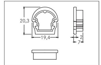
Endkappen-Set zu 53431070, silber. In Verbindung mit den Profilabdeckungen 53431070 kann sowohl ein zusätzlicher mechanischer Schutz als auch eine optimale Lichtverteilung erreicht werden. Material: Aluminium, Abmessung Profil: L: mm x B: 19,4 mm x H: 20,3 mm.
