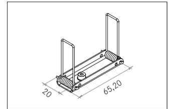
Feder-Halter für Hohlwände, aluminium roh. Material: Stahl, Abmessung Profil: L: 20 mm x B: 65,2 mm x H: mm.
