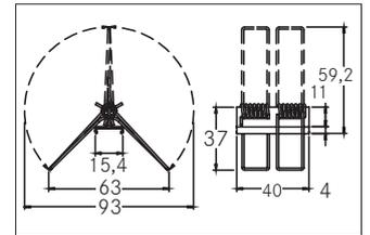
Feder-Halter für Hohldecken, aluminium roh. Material: Aluminium, Abmessung Profil: L: 40 mm x B: 15,4 mm x H: 37 mm.
