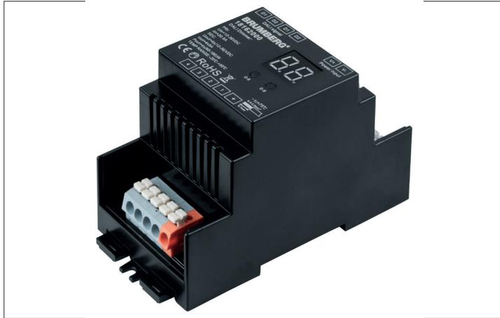
REG LED-Dimmer 12-24 V DC, dimmbar. LED-Dimmer-Serie für Konstantspannungsbetrieb (12-24 V DC) über 4 Kanäle (ein- oder mehrfarbig). Die Verkabelung erfolgt schraublos über Steckklemmen. Leitungsquerschnitt: 0,5-2,5 mm<sup>2</sup>. Zum Betrieb wird eine externe Spannungsversorgung benötigt, Ausgangssignal (Dimmung): PWM (Pulsweitenmodulation), mit Verpolungs- und Übertemperaturschutz.
