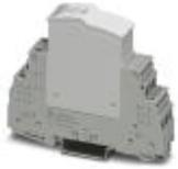
Steckbarer Geräteschutz, gem. Typ 3 / Class III, für 1-phasige Stromversorgungsnetze mit separatem N und PE (3-Leitersystem: L1, N, PE), mit integrierter stoßstromfester Sicherung und Fernmeldekontakt. Auch für DC-Anwendungen geeignet.
