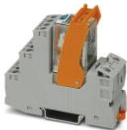
Vormontiertes Relaismodul mit Schraubanschluss, bestehend aus: Relaissockel, Leistungskontaktrelais, steckbarem Anzeige-/ Entstörmodul und Haltebügel. Kontaktausführung: 4 Wechsler. Eingangsspannung: 230 V AC
