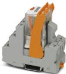
Vormontiertes Relaismodul mit Schraubanschluss, bestehend aus: Relaissockel, Leistungskontaktrelais, steckbarem Anzeige-/ Entstörmodul und Haltebügel. Kontaktausführung: 3 Wechsler. Eingangsspannung: 120 V AC
