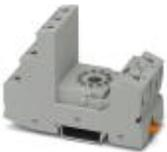
Relaissockel RIF-3..., für Oktalrelais mit 3 Wechslern, Schraubanschluss, Steckmöglichkeit für Eingangs-/Entstörmodule, zur Montage auf NS 35/7,5
