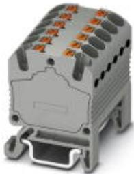
Verteilerblock, intern gebrückt, Nennspannung: 500 V, Nennstrom: 17,5 A, Anschlussart: Push-in-Anschluss, Anzahl der Anschlüsse: 12, Querschnitt: 0,14 mm<sup>2</sup> - 1,5 mm<sup>2</sup>, AWG: 26 - 16, Breite: 27,4 mm, Farbe: grau, Montageart: NS 15
