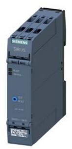
Thermistor-Motorschutzrelais Standard-Auswertegerät 22,5 mm Gehäuse Schraubanschluss 2 Wechsler US = AC/DC 24 V Hand/Fern-RESET mit ATEX-Zulassung 2 LEDs (READY/TRIPPED) galvanische Trennung Test-/RESET-Taste Drahtbruchüberwachung Kurzschlussüberwachung
