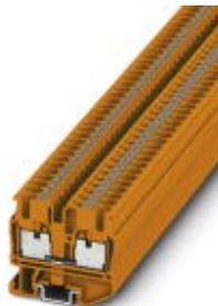
Mini-Durchgangsklemme, Nennspannung: 500 V, Nennstrom: 24 A, Anschlussart: Push-in-Anschluss, Anzahl der Anschlüsse: 2, Querschnitt: 0,14 mm<sup>2</sup> - 4 mm<sup>2</sup>, AWG: 26 - 12, Breite: 5,2 mm, Höhe: 32,1 mm, Farbe: orange, Montageart: NS 15
