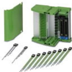
Termination Carrier zur redundanten Anbindung von 16 MINI Analog Trennverstärkern an analoge Eingangskarten der Yokogawa CENTUM VP Steuerung, über KS40-Steckverbinder, 40-polig. Geeignet für die Yokogawa-Karten AAI141 und AAI143.
