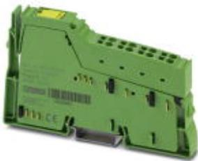
Inline ECO, Analogausgabeklemme, Analoge Ausgänge: 4, 4 mA ... 20 mA, Anschlusstechnik: 2-Leiter, Übertragungsgeschwindigkeit im Lokalbus: 500 kBit/s, Schutzart: IP20, inklusive Inline-Stecker
