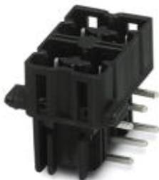
Grundgehäuse, Nennstrom: 8 A, Bemessungsspannung (III/2): 300 V, Polzahl: 6, Rastermaß: 5 mm, Anschlussart: Steck / Lötanschluss, Farbe: schwarz, Kontaktoberfläche: Zinn, Montage: Löten, Bitte beachten Sie die Derating-Kurve des Artikels
