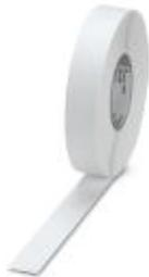
Etikett, Rolle, weiß, unbeschriftet, beschriftbar mit: THERMOMARK ROLL, THERMOMARK ROLL X1, THERMOMARK ROLLMASTER 300/600, THERMOMARK X1.2, THERMOMARK S1.1, Montageart: kleben, Schriftfeldgröße: endlos x 20 mm
