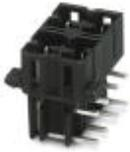
Grundgehäuse, Nennstrom: 8 A, Bemessungsspannung (III/2): 300 V, Polzahl: 8, Rastermaß: 5 mm, Anschlussart: Steck / Lötanschluss, Farbe: schwarz, Kontaktoberfläche: Zinn, Montage: Löten, Bitte beachten Sie die Derating-Kurve des Artikels
