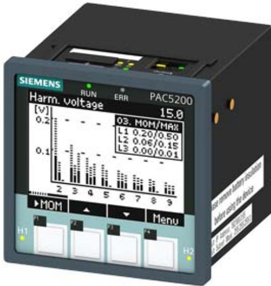
SETRON, Messgerät und power quality recorder, 7KM PAC5200, LCD, L-L: 690 V, L-N: 400 V, 10 A, 3-phasig, Modbus TCP, Schein- / Wirk- / Blindenergie / cos phi, Oberschwingungen: 2. - 40., THD, Klasse 0,5 gem. IEC61557-12 bzw. Klasse 0,5S gem. IEC62053-22, Weitspannungsnetzteil, AC/DC, Schraubanschluss
