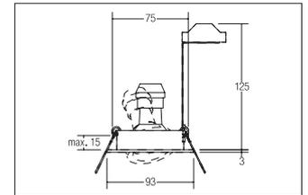
Einbaustrahler, GU10, alu matt, rund. Ausgeführt in kompakter Bauform für werkzeuglose Schnellmontage zum Deckeneinbau. Inkl. Bügel mit GU10-Fassung zur normgerechten Zugentlastung. Ausführung: GU10, Montageart: Einbaumontage, Montageort: Deckenmontage, Material: Aluminium, Schutzart: nach DIN EN 60529: IP20, Schutzklasse: (EN 61140) II, Spannung: 230V AC 50Hz, Leistung: 50W, Anzahl der Leuchtmittel / Fassungen: 1.0 Stk, Verstellbarkeit: schwenkbar, Art der Dimmung: sonstige .
