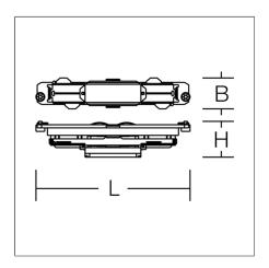
Gerade Kupplung, Kunststoff, abstandslos (eingebaut). Mit integrierter zusätzlicher 2-poliger-DALI-Leitung. Versorgungsleitung 16 A / 400 V. Steuerleitung DALI 2x 1 A / 50 V FELV AC.
