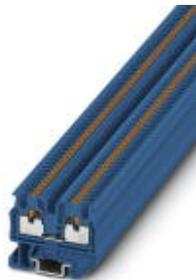
Mini-Durchgangsklemme, Nennspannung: 500 V, Nennstrom: 17,5 A, Anschlussart: Push-in-Anschluss, Anzahl der Anschlüsse: 2, Querschnitt: 0,14 mm<sup>2</sup> - 1,5 mm<sup>2</sup>, AWG: 26 - 14, Breite: 3,5 mm, Farbe: blau, Montageart: NS 15
