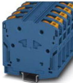
Hochstromklemme, Nennspannung: 1500 V, Nennstrom: 232 A, Anschlussart: Power-Turn-Anschluss, Anzahl der Anschlüsse: 2, Querschnitt: 25 mm<sup>2</sup> - 95 mm<sup>2</sup>, AWG: 4 - 4/0, Breite: 25 mm, Farbe: blau, Montageart: NS 35/15
