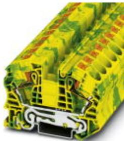
Schutzleiter-Reihenklemme, Anschlussart: Push-in-Anschluss, Anzahl der Anschlüsse: 2, Querschnitt: 0,5 mm<sup>2</sup> - 25 mm<sup>2</sup>, AWG: 20 - 4, Breite: 12,2 mm, Farbe: grün-gelb, Montageart: NS 35/7,5, NS 35/15
