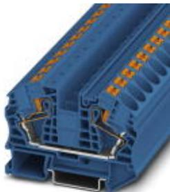
Durchgangsklemme, Nennspannung: 1000 V, Nennstrom: 76 A, Anschlussart: Push-in-Anschluss, Anzahl der Anschlüsse: 2, Querschnitt: 0,5 mm<sup>2</sup> - 25 mm<sup>2</sup>, AWG: 20 - 4, Breite: 12,2 mm, Farbe: blau, Montageart: NS 35/7,5, NS 35/15
