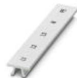
Marker für Klemmen, Streifen, weiß, beschriftet, längs bedruckt: L1, L2, L3, N, PE, Montageart: verrasten in hoher Schildchennut, für Klemmenbreite: 12,2 mm, Schriftfeldgröße: 10,5 x 12,15 mm
