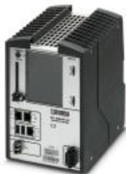
Hochverfügbarer Remote Field Controller mit Redundanzfunktion, 3x 10/100 Ethernet, PROFINET-Controller, Schutzart IP20, steckbarer Parametrierungsspeicher
