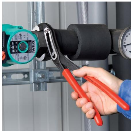
Selbstklemmend an Rohren und Muttern: kein Abrutschen am Werkstück; die gesamte Betätigungskraft kann zum Drehen der Werkstücke eingesetzt werden; festes Zusammendrücken der Zangenschenkel ist nicht erforderlich, dadurch weniger Kraftaufwand
