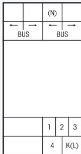
**Stromstoß-Schaltrelais mit 4 Kanälen, je 1 Schließer 230V-LED bis 400 W, Glühlampen bis 1800 W, potenzialgetrennt von der Versorgungsspannung, mit DX-Technologie. Bidirektional. Stand-by-Verlust nur 0,1 Watt.**
