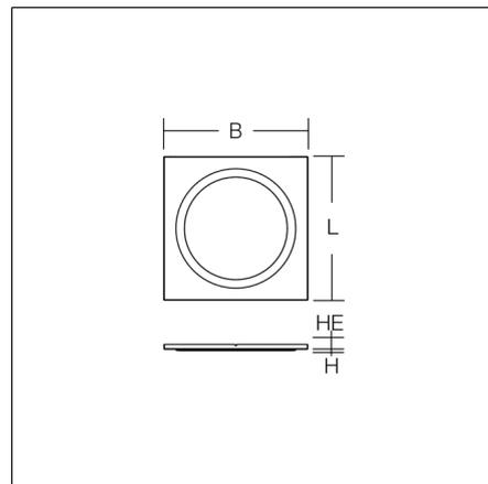
Einlegerahmen für Rasterdecken Modulmaß 625. Rahmen aus Stahlblech, pulverbeschichtet. Für Einbau-Downlight Toledo Flat D 495.
