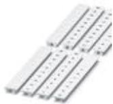
Marker für Klemmen, Streifen, weiß, beschriftet, beschriftbar mit: CMS-P1-PLOTTER, längs: L1, L2, L3, N, PE, L1, L2, L3, N, PE, Montageart: verrasten in hoher Schildchennut, für Klemmenbreite: 8,2 mm, Schriftfeldgröße: 10,5 x 8,15 mm
